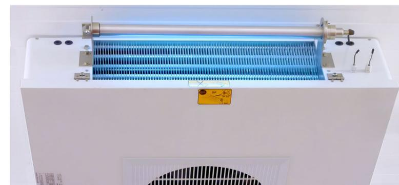
Les appareils UVC de sterilAir s'intègrent facilement dans les processus existants.
